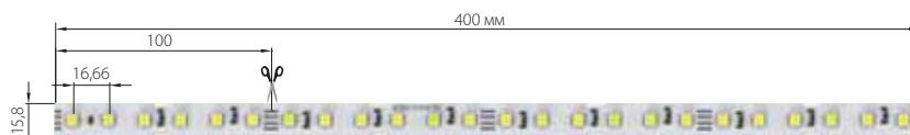
BT60: 60 шт/м, с 3 ножками - SMT 20 мА на печатной плате FR4 / 24 В - 14 Вт/м - *1440 лм/м BT60R: 60 шт/м, с 3 ножками - SMT 20 мА с линейной регулировкой на печатной плате FR4 / 24 В - 14 Вт/м - *1440 лм/м
